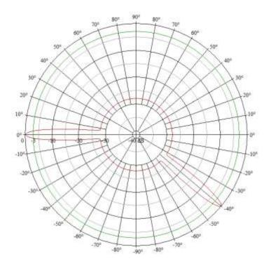
Antenna horizontal diagramm 000ND00 (omni)
